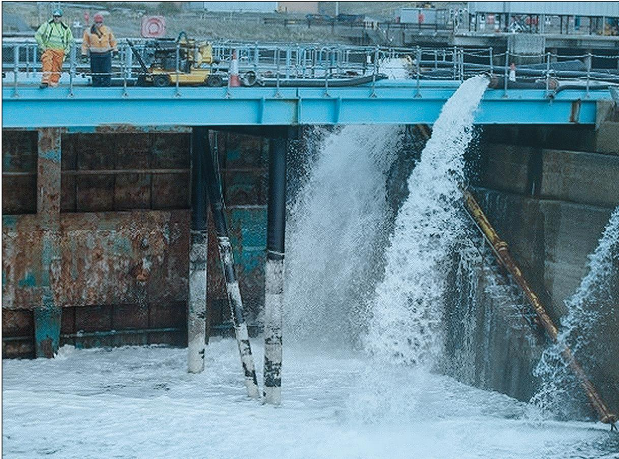
Für die Tests wurde ein Unterwasserdock mit nachgebildetem Meeresboden verwendet. Salzwasser wurde von der Nordseemündung des River Blyth eingepumpt.
