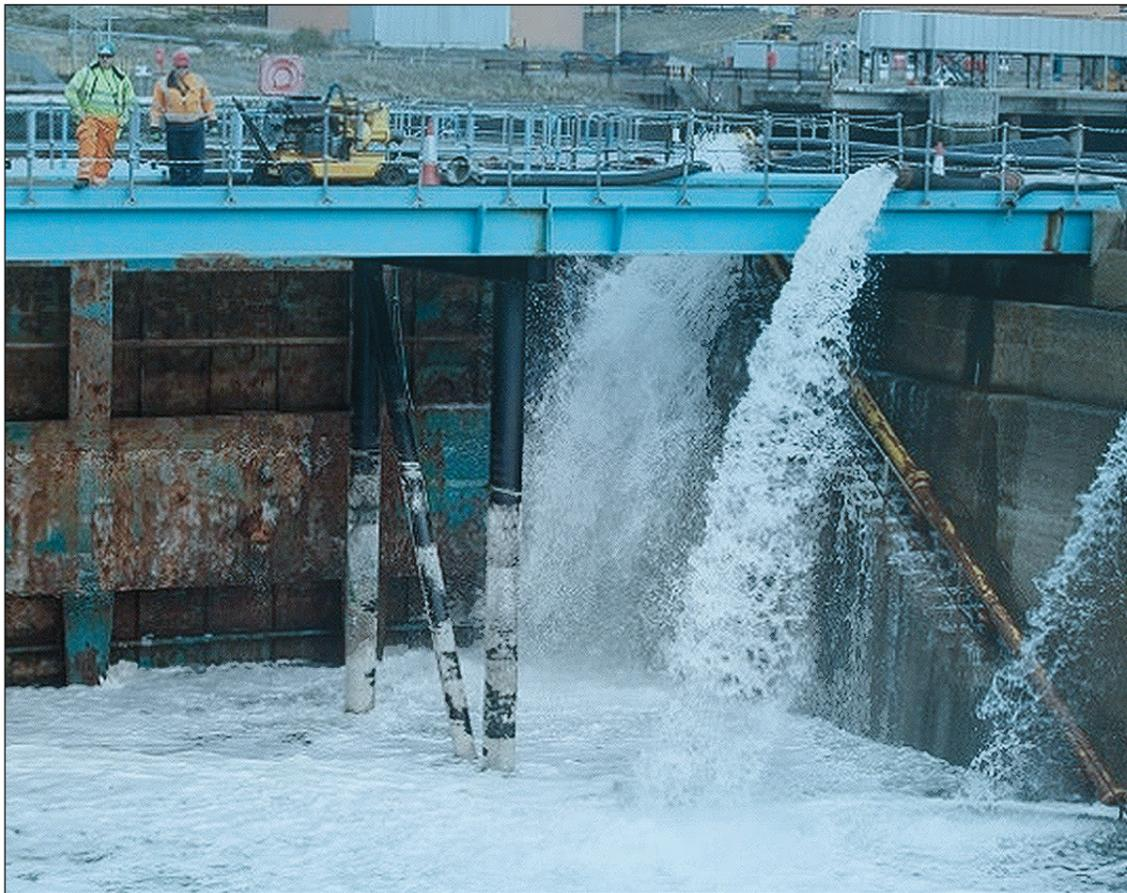
Für die Tests wurde ein Unterwasserdock mit nachgebildetem Meeresboden verwendet. Salzwasser wurde von der Nordseemündung des River Blyth eingepumpt.
